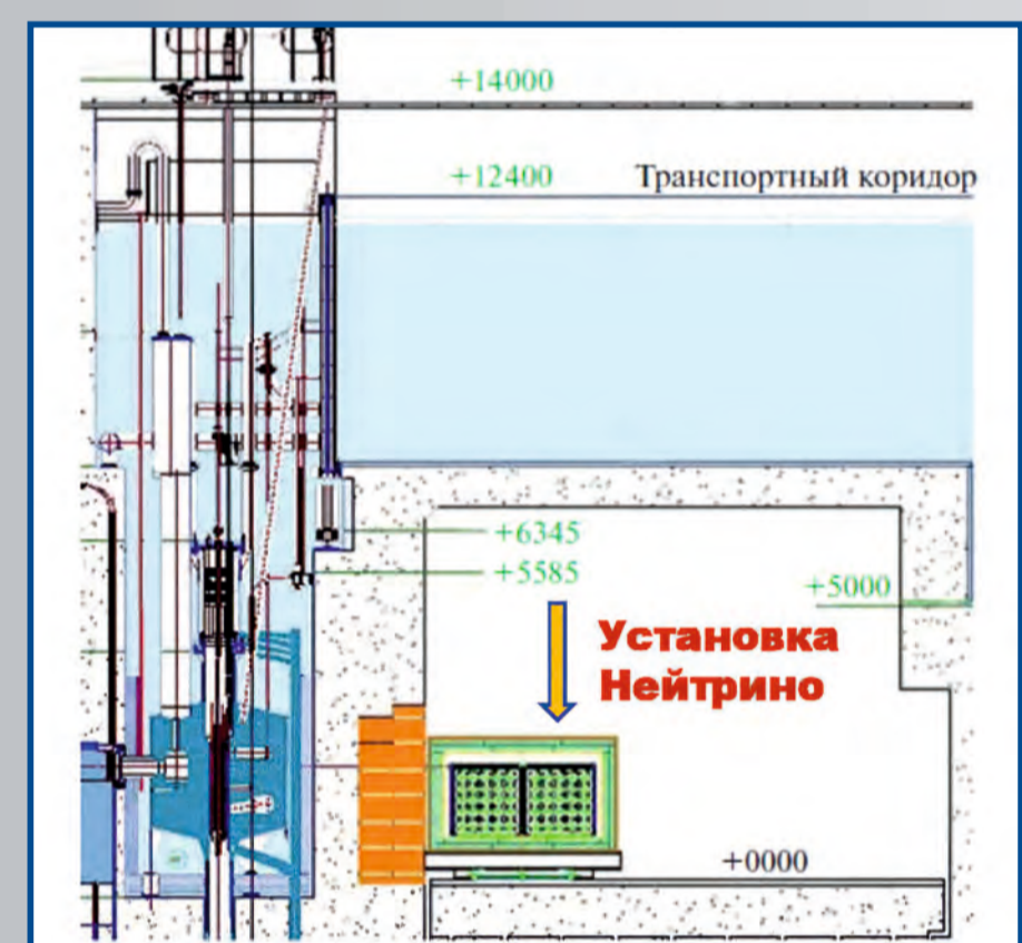
Схема размещения установки «Нейтрино» на реакторе ПИК
